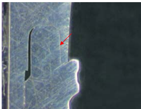
Abb. 3: Schnitt durch die Anschlussstelle von Abutment zu Implantat. Die Kante zwischen den sich berührenden Flächen ist nahezu unsichtbar (Pfeil)
